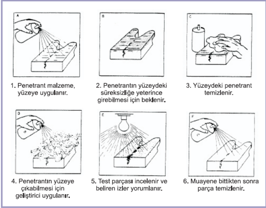
Şekil 3. Sıvı Penetrant ile Muayenenin Temel Aşamaları
